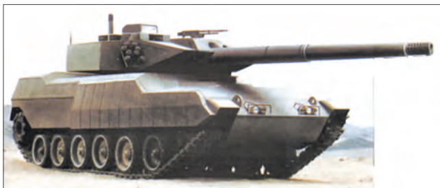
Опытный образец легкого танка «Стингрей-2» со 105-мм пушкой
