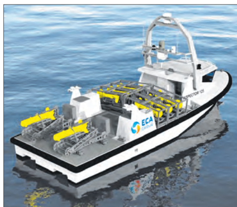
Безэкипажный катер «Инспектор 125» с комплектом противоминного вооружения
