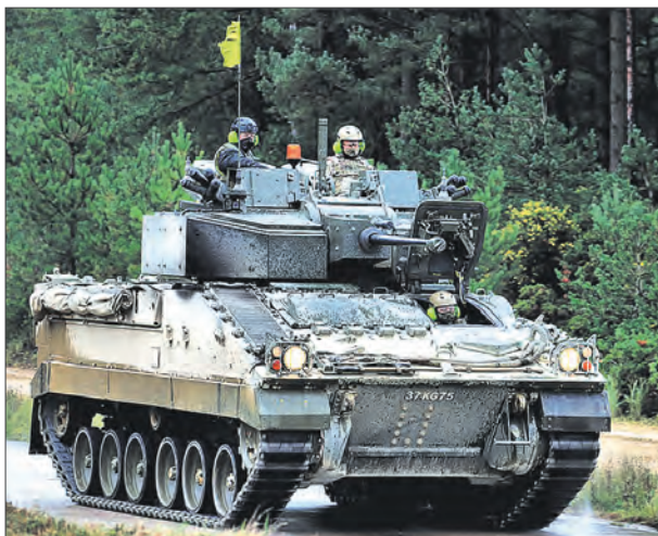
Боевая машина пехоты «Уорриор», вооруженная 30-мм автоматической пушкой L21A1
